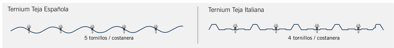
\* Fijación sugerida, tomando como base un tornillo autotaladrante con arandela de neopreno.
