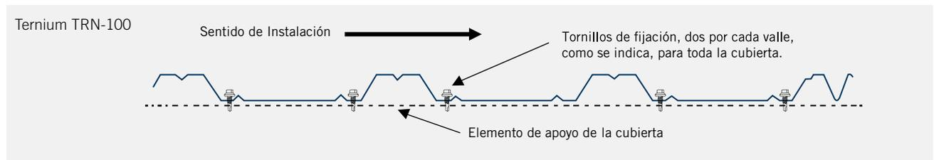
\* Fijación sugerida, tomando como base un tornillo autotaladrante con arandela de neopreno.
