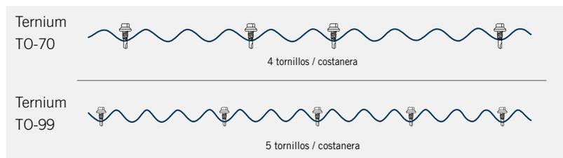
\* Fijación sugerida, tomando como base un tornillo autotaladrante con arandela de neopreno.
