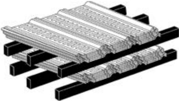
No se recomienda utilizar plásticos para cubrir el material almacenado. El uso prolongado de estos elementos pueden generar una cámara de condensación y provocar humedad en el material.
