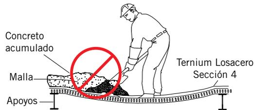
7. Si el concreto es bombeado, la manguera aplicadora deberá estar lo más bajo posible para evitar el impacto del concreto sobre la lámina. Una práctica general es verter el concreto sobre los apoyos y simultáneamente expandirlo a otras áreas.
