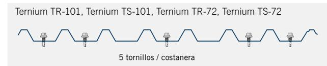
\* Fijación sugerida, tomando como base un tornillo autotaladrante con arandela de neopreno.
