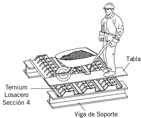
6. Se deberá colocar el concreto de manera uniforme sobre toda el área, de tal manera, que éste no se acumule para evitar deformaciones excesivas antes de que fragüe. Como recomendación general, se deberá mantener constante el espesor especificado en la selección de la Ternium Losacero, en ningún caso deberá ser menor a 5 cm.
